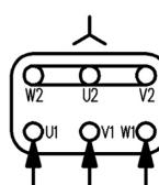
**Collegamento per motori a 2 velocità, unico avvolgimento**
